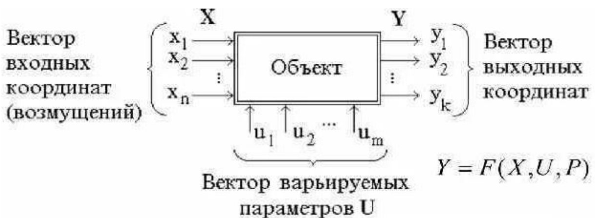
Рисунок 3.1 – Общая схема и задача параметрической идентификации
